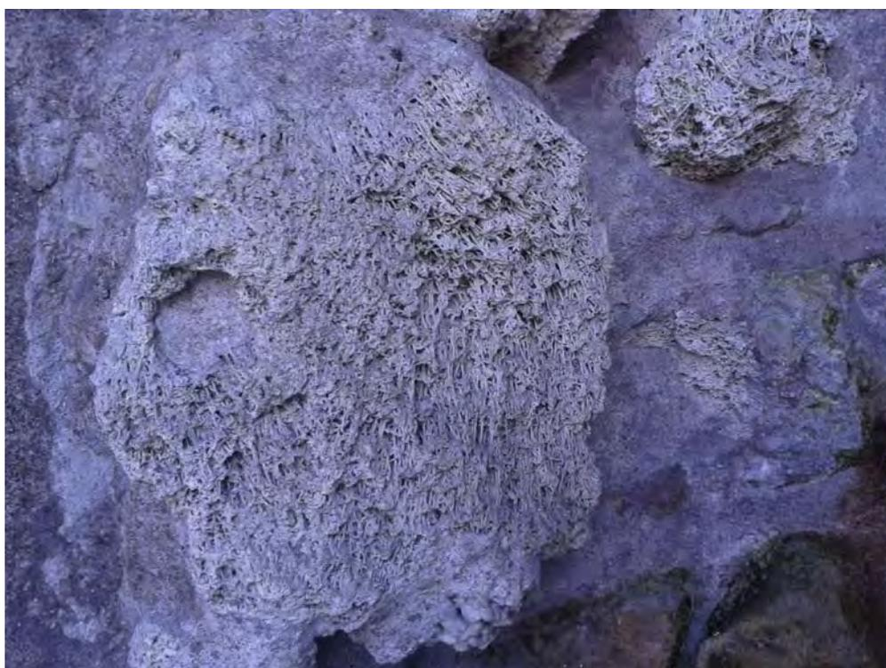
Fig. 8. – Particolare di un blocco di travertino fitoclastico caratterizzato dalla tipica struttura con numerosi vuoti interposti tra le concrezioni di calcite.
